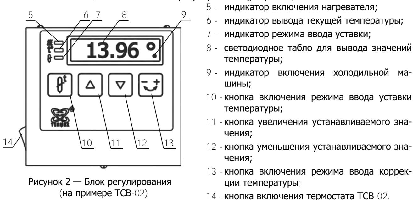
Рисунок 2 — Блок регулирования
